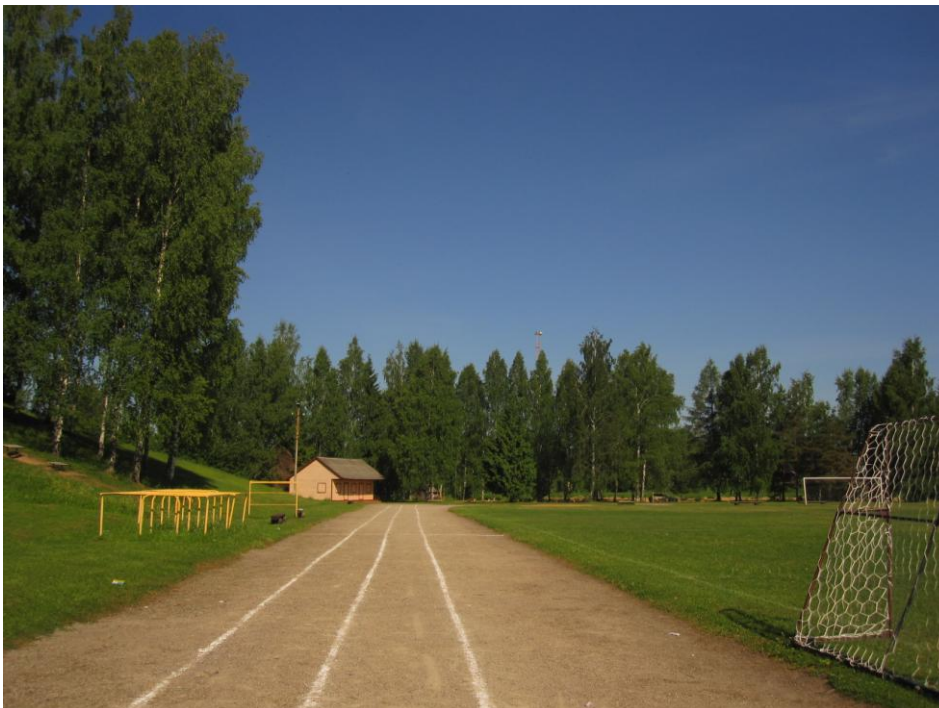
Vaade 4. Vaade 100 meetri jooksurajale. Olemasolevaid radasid on kavas laiendada 6-realiseks jooksurajaks, iga raja laiuseks on kavandatud 1,22 meetrit. Uue jooksuraja katteks on planeeritud kummikate, mille alla tuleb kõvakate. Jooksuraja servad vajavad taastamist. Jooksuraja mäekiinka poolsesse serva on planeeritud rajada 2 meetri laiune kruusakattega jalgte. Mäekiinkale kasesalu alla on planeeritud istepingid spordivõistluste pealtvaatajatele.
